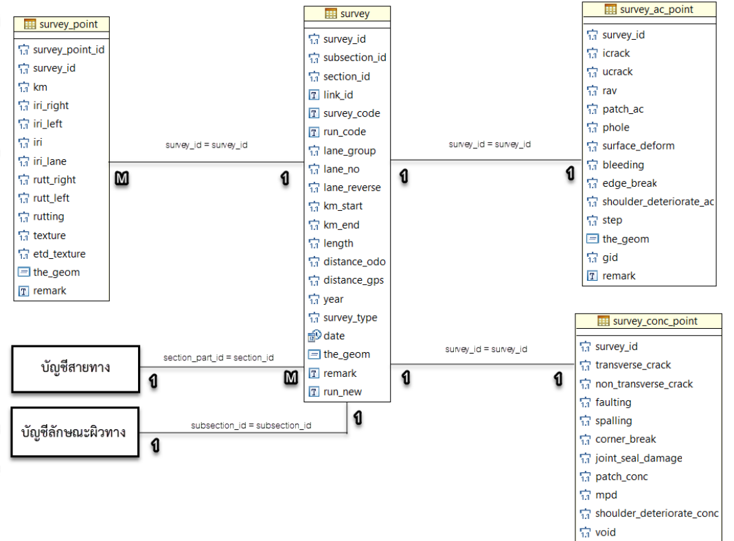
แสดงรูปแบบการเชื่อมโยงของข้อมูลสำรวจจากสำนักบำรุงทาง
